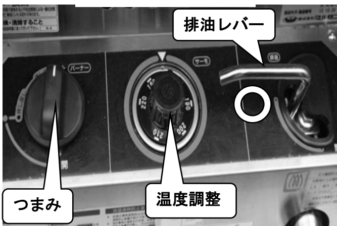
図5 フライヤー操作盤
