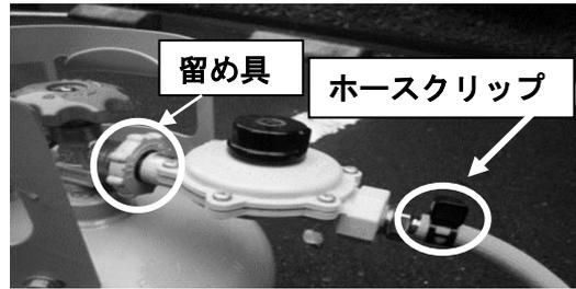
図2 圧力調整器 (ガスボンベ接続)
