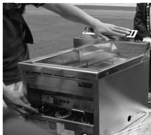
図7 フライヤー着火の様子
